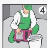
Для подготовки раствора залейте водопроводную воду комнатной температуры в чистую ёмкость из расчёта 0,34 - 0,36 л воды на 1 кг сухой смеси.
