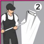
Обработайте основание грунтовочными составами БОЛАРС, соответствующими вашему типу поверхности. При нанесении на цокольную часть фасада необходимо обработать поверхность грунтом БОЛАРС "Sil-primer" или "Sil-primer Quartz" для повышения влагостойкости основания.
