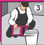
Для подготовки раствора залейте водопроводную воду комнатной температуры в чистую емкость из расчета 4,5-5,5 л воды на 1 мешок (25 кг).
