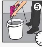
Перемешайте раствор дрелью со специальной насадкой на низких оборотах, засыпая сухую смесь в воду до получения однородной массы. Подождите 3-5 минут, после этого перемешайте вторично. Время пригодности раствора к работе - 3 часа. При температуре воздуха до -10°C раствор находится в рабочем состоянии не менее 30 минут.
