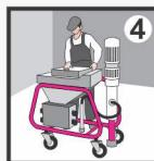
При механизированном нанесении смесь приготавливается в машинах для перемешивания и подачи штукатурного раствора. Сухую смесь засыпать в бункер штукатурной станции. Произвести регулировку подачи воды (количество воды определяется типом штукатурной машины) для соответствия требуемой консистенции раствора (ориентируясь на показатель подвижности Пк3).
