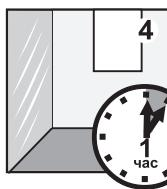
Загрунтованную поверхность оберегайте от запыления. Дальнейшие отделочные работы можно проводить не ранее чем через 1 час после нанесения последнего слоя грунта. Данный норматив времени соответствует условиям t воздуха +20°C и относительной влажности 60%. При других температурно-влажностных условиях время высыхания грунта может изменяться.
