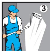
Грунт готов к применению. Запрещается дополнительное введение в грунт воды и других компонентов. Грунт наносится на основание в один слой кистью или валиком. Работы следует проводить при температуре воздуха и основания от +5°C до +30°C и относительной влажности воздуха не более 80%. Не допускайте скопления излишка грунта на поверхности и появление блестящей пленки. Сильно впитывающие поверхности необходимо грунтовать в 2 слоя с промежуточной сушкой в течение 1 часа.
