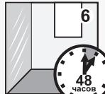
Работы следует проводить при температуре воздуха и основания от +15 до +30°C и относительной влажности воздуха не более 75%, при условии, что температура массы клея не ниже +10°C. Рекомендуемая влажность основания не более 10%. Время высыхания 48 часов. Время полного отверждения 72 часа.
