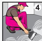
Перед применением клей следует тщательно перемешать. Клей БОЛАРС LinoleumFix нанести зубчатым шпателем А2 (для гладкой основы) или В1 (для рельефной основы) по всей плоскости пола и оставить для подсушки на 5-20 минут.
