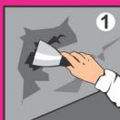
Склейываемые поверхности должны быть ровными, сухими, очищенными от пыли, жира и грязи.
