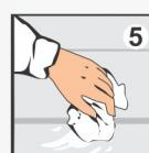
После нанесения остатки клея сразу удалите влажной губкой, инструменты промойте водой с моющими средствами. Эксплуатацию склеенных поверхностей можно начинать после полного отверждения.
