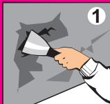
Подготовьте основание. Удалите с него ослабляющие сцепление вещества: масляные и битумные пятна, пыль и прочие загрязнения. Отслаивающиеся участки удалите стальным шпателем. Нанесение краски на старые масляные шпатлевки и краски возможно только после предварительной очистки.
