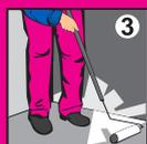
3 Обработайте основание грунтом БОЛАРС «Глубокого проникновения». Сильно впитывающие поверхности необходимо загрунтовать дважды.
