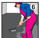
6 Для удаления избыточного воздуха сразу после заливки смесь прокатайте игольчатым валиком. Выравнивание поверхности производите за один прием, без перерывов. При заливке помещений более 40 м<sup>2</sup> необходимо нарезать деформационные швы с последующим заполнением герметиком.
