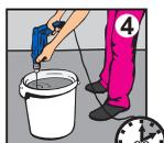
4 Для приготовления растворной смеси возьмите точно отмеренное количество чистой воды комнатной температуры: на 1 кг сухой смеси 0,26-0,28 л воды (на 1 мешок 20 кг - 5,2-5,8 л). Равномерно засыпая сухую смесь в воду, перемешивайте раствор дрелью с насадкой на низких оборотах до получения однородной пастообразной массы. Раствор необходимо выдержать 3-5 минут, после этого повторно перемешать и использовать по назначению. Время пригодности раствора к работе не менее 30 минут.
