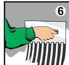
Шпатлевку БОЛАРС «Фасадная Финишная» нанесите стальным шпателем на основание слоем от 0,2 до 2 мм. Для получения более толстого слоя допускается шпатлевание в несколько слоев. Последующий слой нанесите после полного высыхания предыдущего, предварительно прогрунтовав поверхность грунтом БОЛАРС «Укрепляющий».
